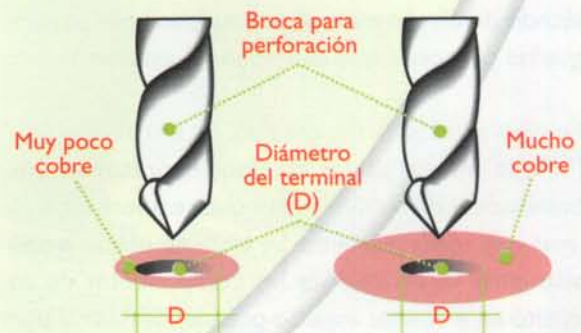
Figura 5.10. Diámetro externo de los puntos de conexión
